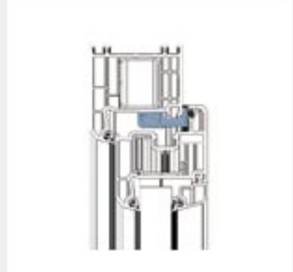
Profilschnitt mit eingebautem AEROMAT mini
